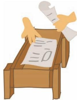
7. **Ahora colocamos el plástico en el contenedor.** Antes de colocar el plástico, coloque papel de diario sobre las tablas para evitar daños al plástico por causa de las astillas o clavos.
