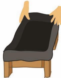
8. **El plástico debe quedar en contacto con las esquinas y con la base.**
