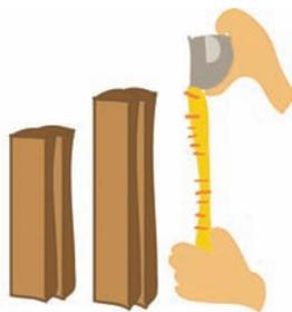
1. Medir y cortar dos tablas de 1,04 m y dos de 1,00 m.
