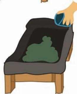
10. **Colocación del sustrato.** Se coloca el sustrato empezando desde el punto de drenaje y se extiende al resto del contenedor. Llenar hasta 1 cm bajo el borde del contenedor.
