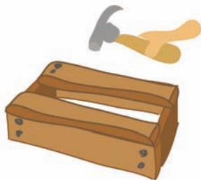
3. Formar la base del cajón clavando las tablas de 1,04 m de largo en la parte que irá hacia abajo. Colocar primero las tablas de los extremos bien alineadas con las del marco.
